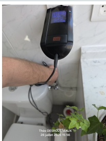
CATU DT300 avec cordon de continuité (photo A31)
