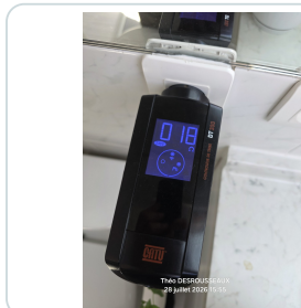
A30 - mesure de continuité / boucle
